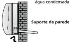
A linha T-Pro possui no **suporte de parede** duas hastes de apoio articuláveis que permitem afastar o gabinete da parede sem a necessidade de remoção da unidade interna da parede, para permitir o acesso a tubulação da linha de líquido e de gás para efetuar as conexões ou fazer a inspeção e verificação de vazamentos.
