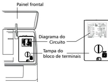
**⚠ O cabo que conecta as unidades externa e interna deve ser adequado para uso externo. Certifique-se que exista uma conexão de terra eficiente.**
