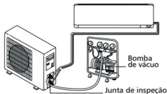
1. Solte a tampa de proteção das válvulas das linhas de líquido e de sucção.
