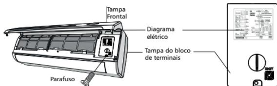
Após a finalização da interligação elétrica é obrigatório efetuar a montagem da tampa da caixa elétrica. Siga as instruções abaixo:
