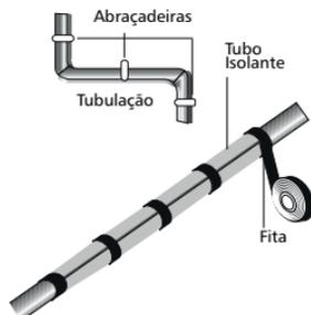
2. Fixe a parte excedente do cabo elétrico na tubulação ou na unidade externa.
