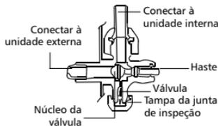
2. Solte e remova a porca de serviço da junta de inspeção.
